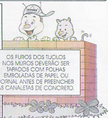
DEPOIS DE COMPLETA A ALTURA, EFETUAMOS O TRAVAMENTO AÉREO USANDO TIJOLOS COM CANALETAS, EM SEGUIDA COLOCAMOS BARRAS DE FERRO DENTRO DAS CANALETAS EM TODA A EXTENSÃO DO MURO.
